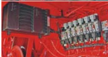
Las órdenes de comando impartidas desde la codera ingresan a la caja procesadora mediante un único cable (comunicación serial) y ésta se encarga de comandar al conjunto de electroválvulas Cetop 3, las cuales se encuentran montadas sobre una placa "manifold" de aluminio.
