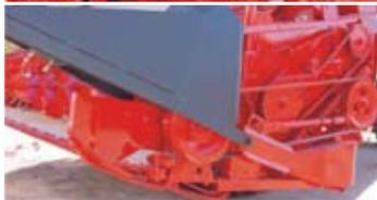
En plataformas de 28 pies, se provee, en forma estándar, con sistema de corte accionado por doble caja de cuchillas, con sus dos correspondientes cuchillas independientes.
