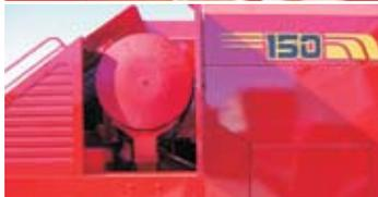
El aire de enfriamiento del motor diesel ingresa a través de un chupador giratorio autolimpiante, evitando el ingreso de partículas que puedan obstruir el radiador.
